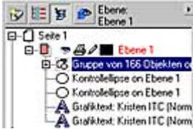
**3** Die Reihenfolge der Einträge entspricht der Lage der Objekte: Der oberste Eintrag liegt über allen anderen Objekten und so weiter.
