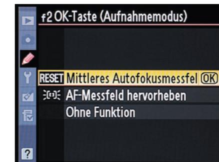
Wenig sinnvoll ist dagegen die zweite Option, bei der das aktuelle Messfeld hervorgehoben wird, wenn Sie die OK-Taste drücken. Da das Autofokus-Messfeld sowieso mit einem Rahmen hervorgehoben wird, können Sie auf die zweite Option verzichten.
