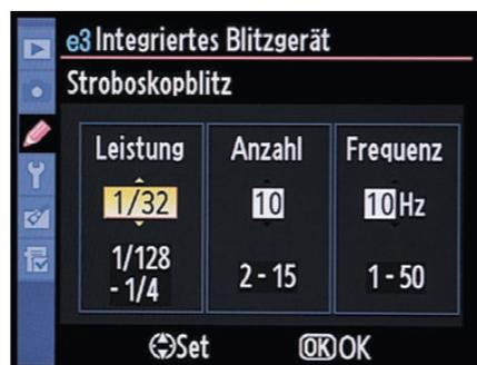
**4** Die letzte Option benötigen Sie, wenn das integrierte Blitzgerät als Master-Blitzgerät benutzt werden soll, um weitere Blitzgeräte zu steuern. So lassen sich über Advanced Wireless Lighting ein oder mehrere externe Blitzgeräte steuern. Beachten Sie, dass alle Geräte auf denselben Kanal eingestellt sein müssen.
