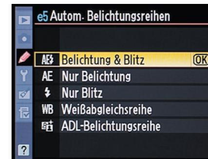
Standardmäßig werden bei der Belichtungsreihe Belichtung sowie Blitz variiert. Zudem können Sie auch beides voneinander trennen und nur eine Belichtungs- oder eine Blitzbelichtungsreihe durchführen. Daneben wird hier auch
