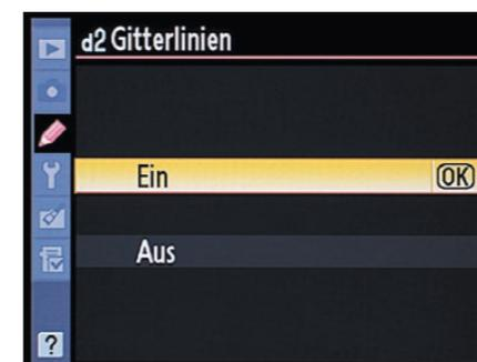
Die Linien werden allerdings nach dem Durchdrücken des Auslösers nur einen Moment lang rot – danach erscheinen sie wieder in Schwarz. Das ist im Dunkeln ein klein wenig lästig, da Sie wiederholt den Auslöser drücken müssen, um die Kamera korrekt ausrichten zu können.
