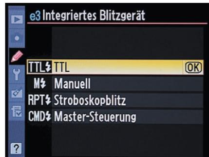
Standardmäßig ist die *TTL*-Option vorgegeben, bei der die Blitzleistung der Situation automatisch angepasst wird. Meist erhalten Sie damit bereits ganz ordentliche Ergebnisse.
